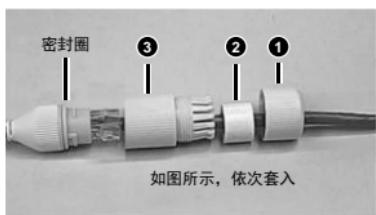
先将密封圈套在电口上，再如图所示，依次套入防水螺帽、筒型防水圈、防水螺栓（筒型防水圈塞入防水螺栓中，防水螺帽拧在防水螺栓上），将网线插入电口完成防水连接。
